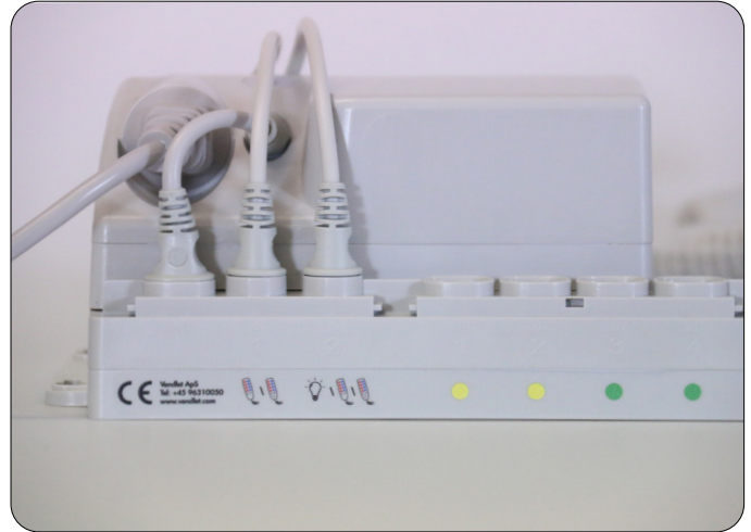
Håndbetjeningen tilsluttes kontrolenheden
