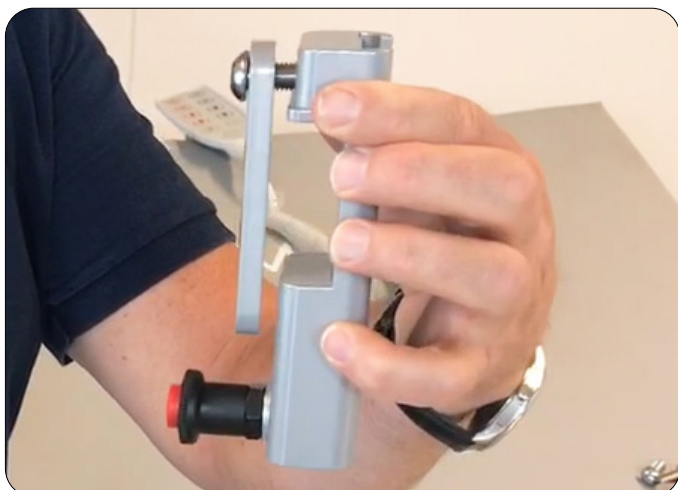
Låsepladen skrues fast på monteringsbeslaget med den øverste skrue
