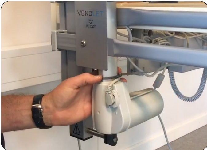
PlacFastgør aktuatorkablet på bagsiden af aktuatoren med strips
