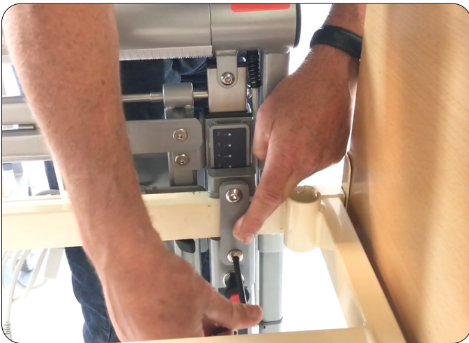
Fastgør monteringsbeslagene ved at spænde begge bolte
