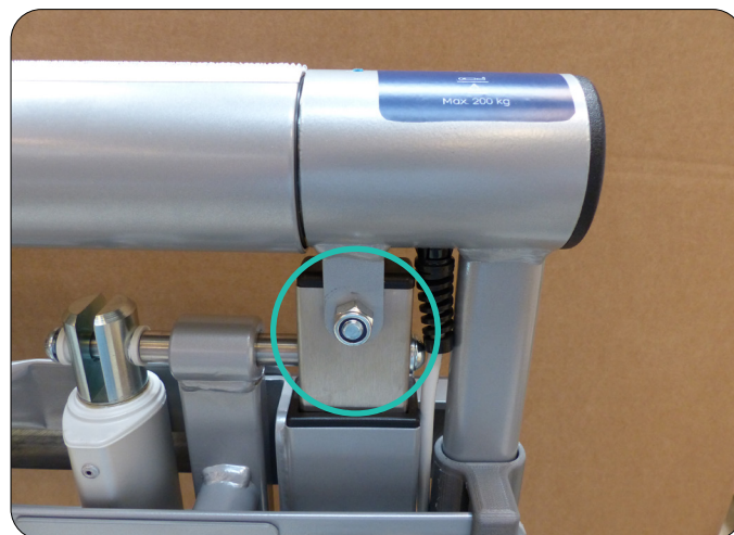
Afmonter motorrullen fra aktuatorbenet
