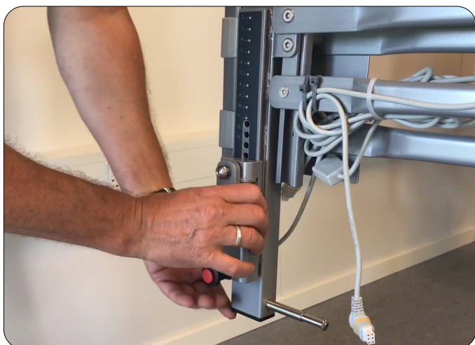
Monter beslaget på VENDELT systemet nedefra og op
