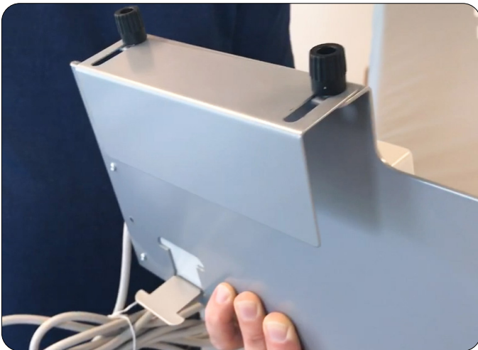
Løsn skruerne på ophængspladen til kontrolenheden
