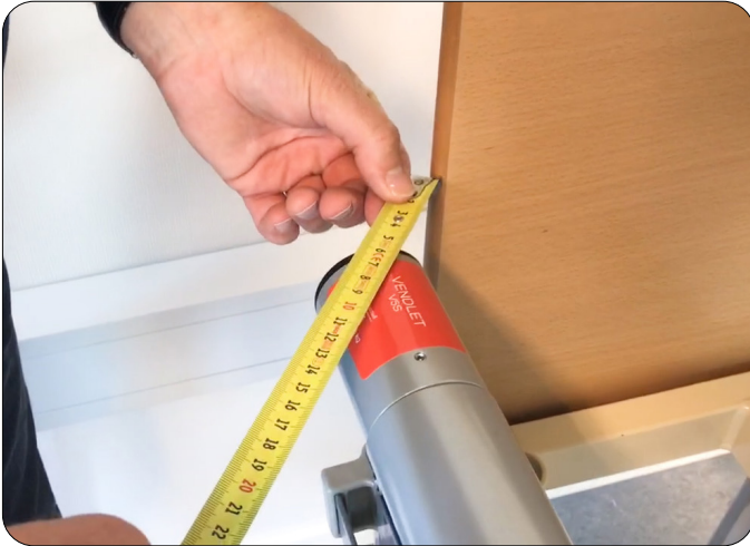
Juster VENDLET systemets placering på sengerammen, så der er max 6 cm i mellem senggavlene og VENDLET systemet
